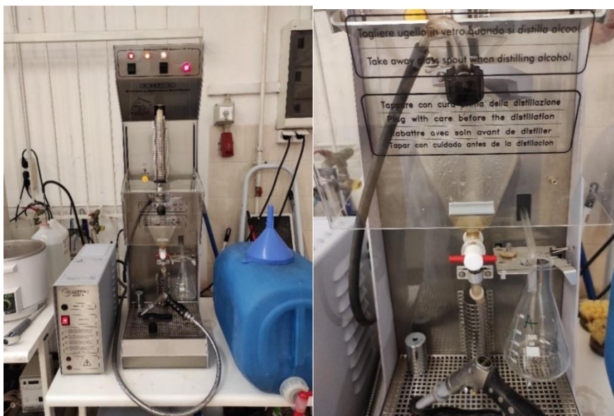
8.ábra. Desztilláció Gibertini készüléken
