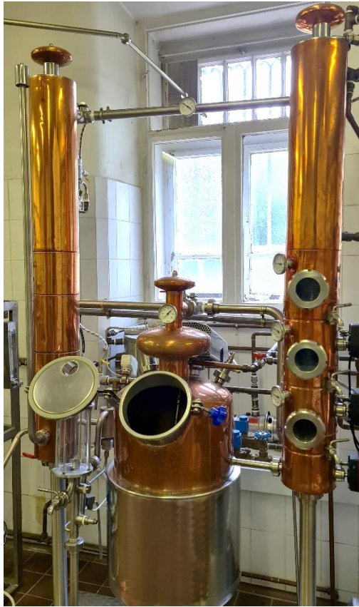
2. ábra: Hagyó-Spirit lepárlóberendezés, MATE (Forrás: saját munka)
