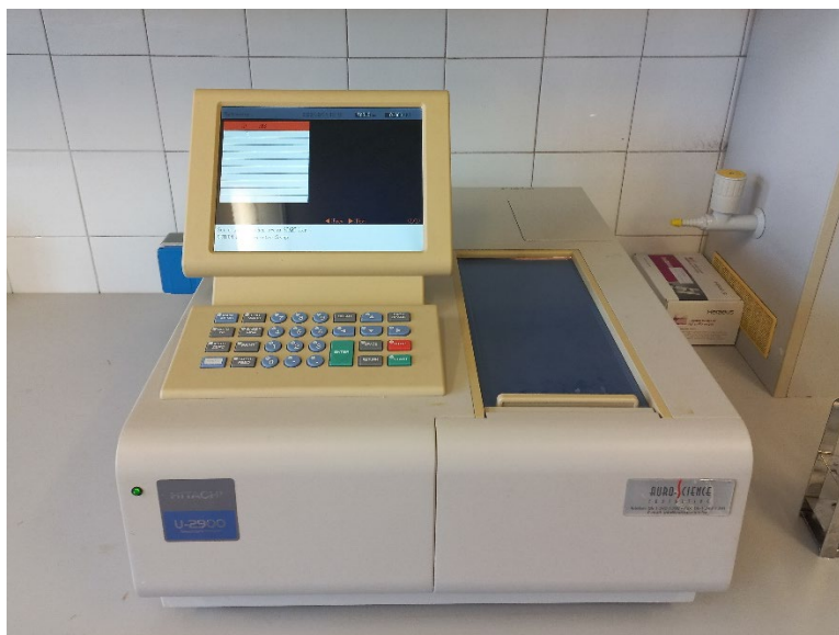
29. ábra: Hitachi U-2900 spektrofotométer (Forrás: Saját fénykép)
