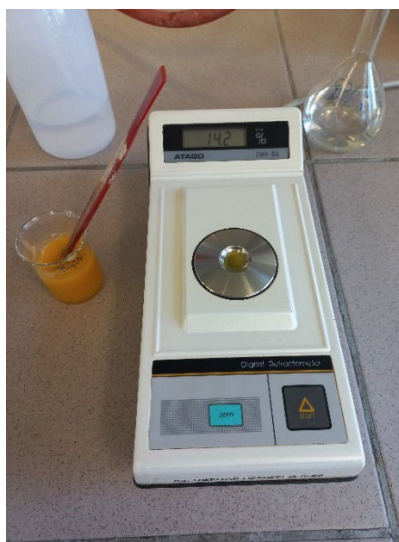
20. ábra: A befőtt minta bemérése refraktométerrel (Forrás: Saját fénykép)
