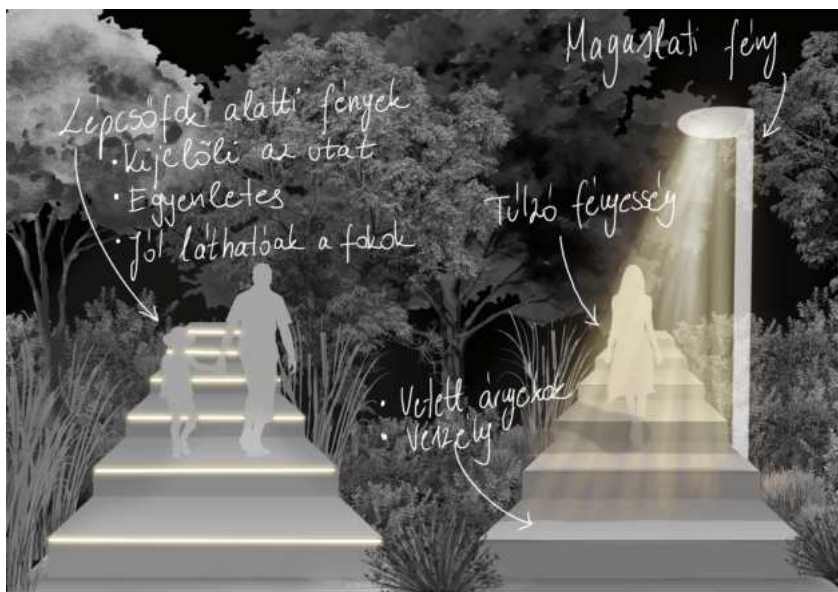
16. ábra - Két másféle módszerrel megvilágított lépcső. A bal oldali egy előnyösebb megoldás, jobban látható a lépcső teljes hossza és fokai. A jobb oldali magaslatti fény bizonyos pontokon túl fényes, míg máshol több vetett árnyékot is képez, ami veszély helyzeteket teremthet a lépcső használata közben. Fotrás: Saját készítésű digitális rajz.
