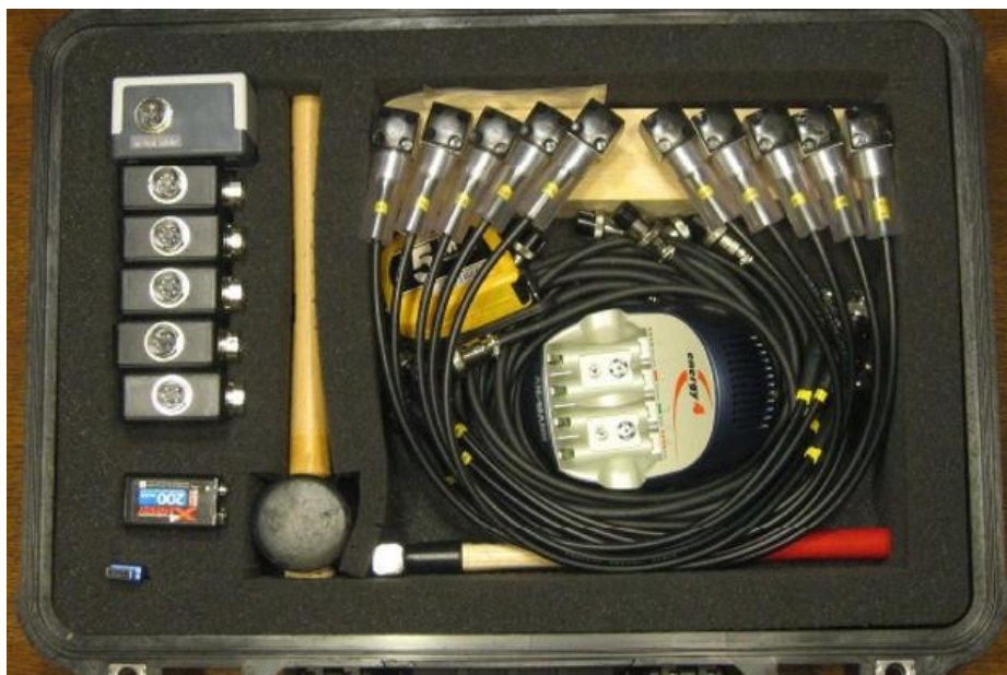
2.ábra ArborSonic 3D akusztikus tomográf (forrás: fakopp.hu )
