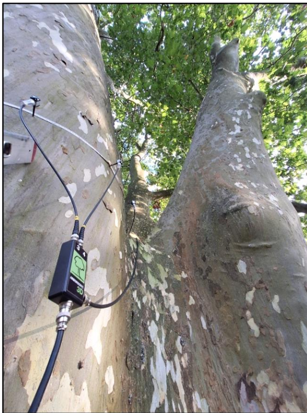
2. ábra: Fakopp mérés a sudáron
