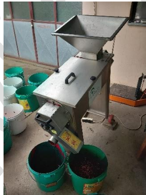
6. ábra: Eniotalia magozógép ( Forrás: Saját kép )
