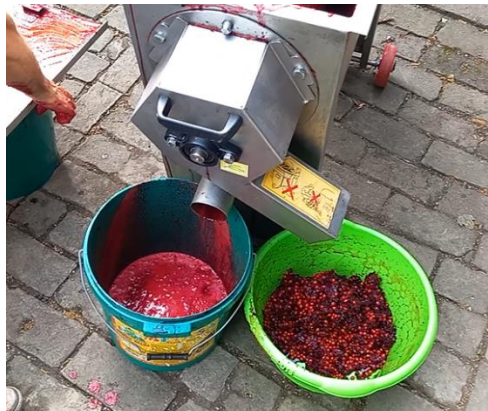
7. ábra: a magozógépből kijött mag és lé szepatátum ( Forrás: Saját kép )
