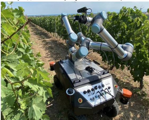
8. ábra: A BACCHUS Projekt szüretelő és felmérő robotjai (Forrás: https://bacchus-project.eu/cases )
