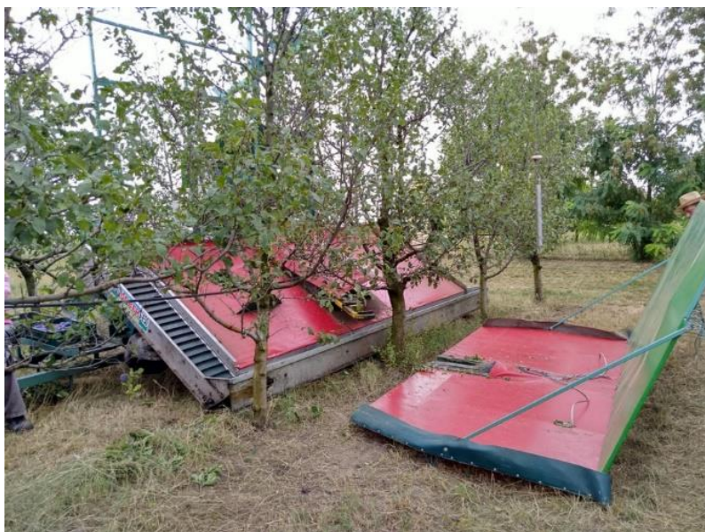
6. ábra Meggy és szilva betakarító gép, (saját forrás)
