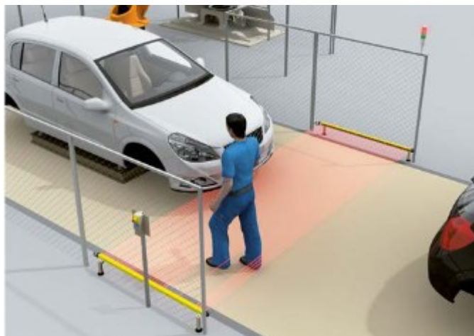
14. ábra „Entry-exit” funkció vízszintesen elhelyezett biztonsági fényfüggőnnyel egy autógyártási gyártósor megmunkáló állomásában [7]
