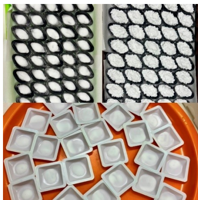
19. ábra: 4.0g \text{MgSO}_4 , 2,5g puffer sókeverék és 150mg primer-szekunder-amin műanyag csónakokba
