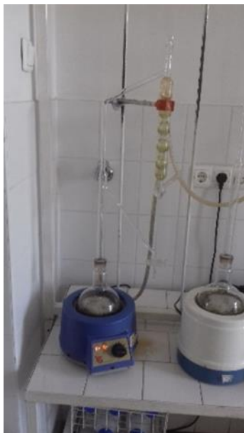
9. ábra: Az illóolaj desztillálás folyamata Clevenger típusú készülékkel.
