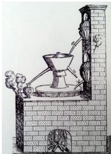
2. ábra: „Mórfejes” lepárló a 15. századból. Forrás: INTERNET 2.
