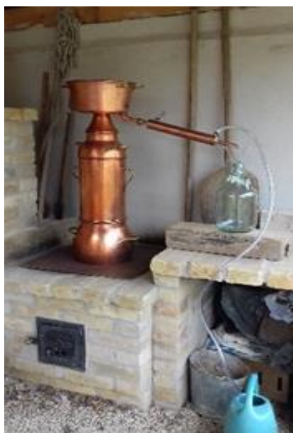
6. ábra: Illóolaj lepárló készülék működés közben. Forrás: saját felvétel, 2022.05.23.
