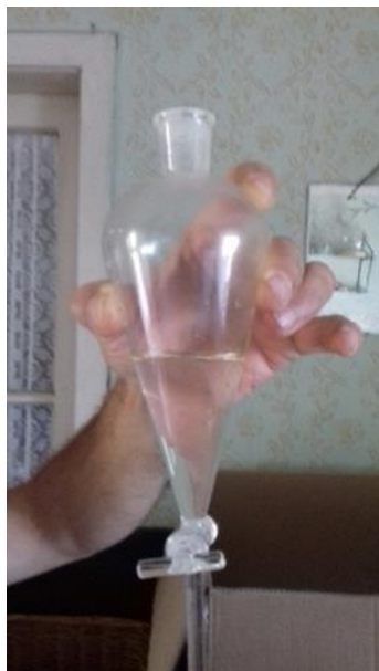
7. ábra: Olajelválasztó üvegtölcsér. Forrás: saját felvétel, 2022.05.24.
