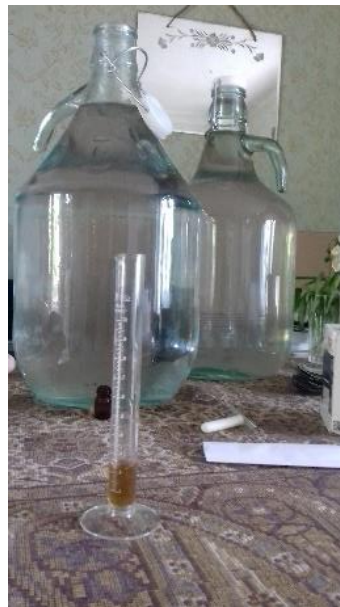
8. ábra: Mérőcső az illóolaj-kihozatal megállapításához. Forrás: saját felvétel, 2022.05.24.
