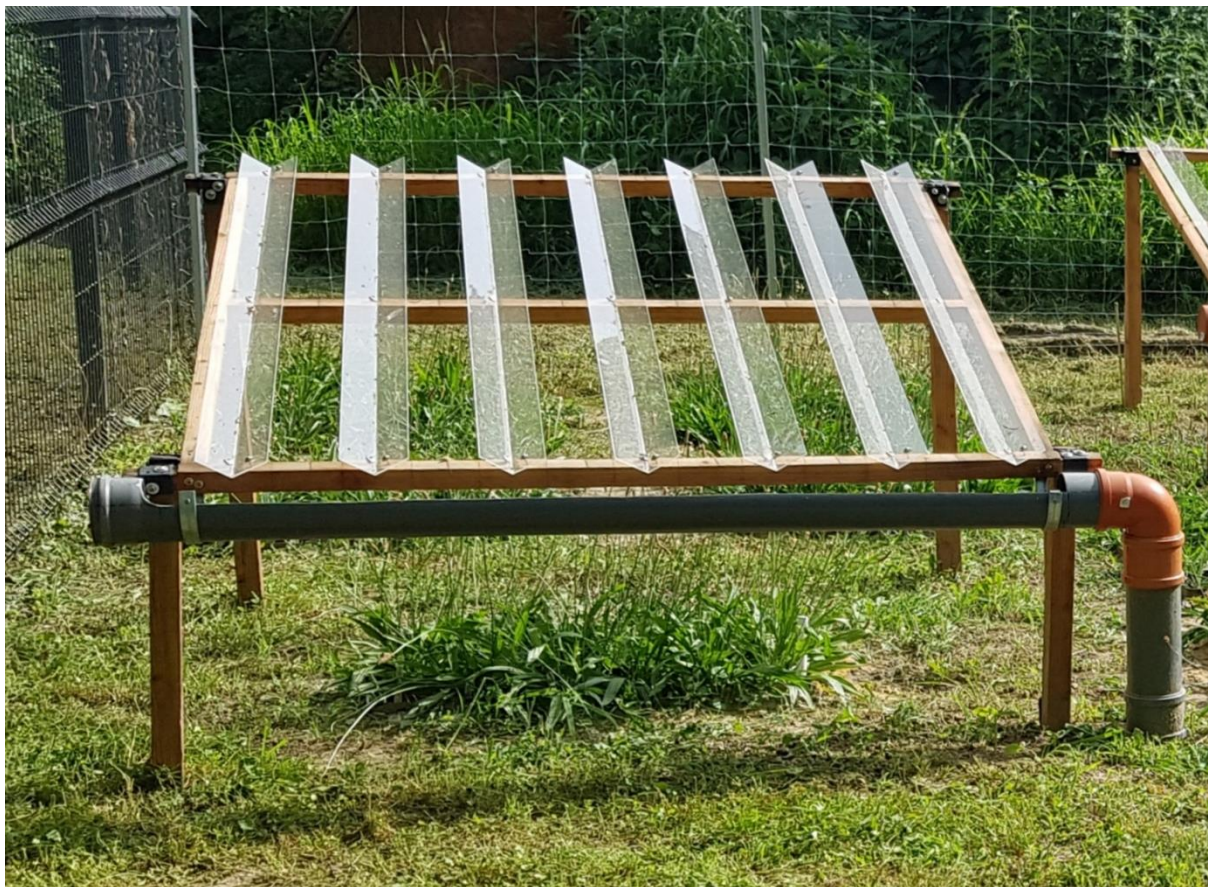
5. ábra: Esőkizáró a keszthelyi kísérleti területen
