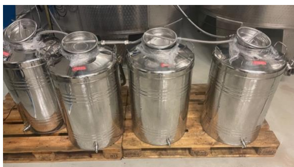
6. ábra Szén-dioxid macerálásra szolgáló 120L kóracél szabályozott tartályok, és felhasznált néró alapanyag
