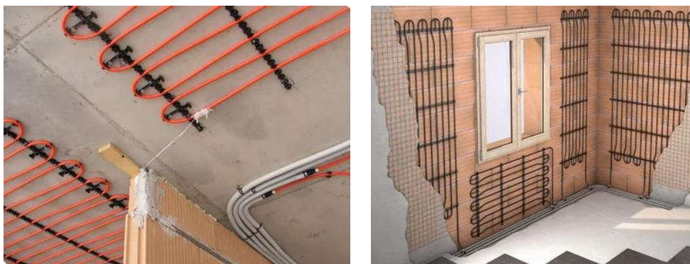
19. ábra: Mennyezethűtés és falhűtés felépítése (Forrás: Wavin, 2020)
