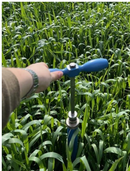
9.ábra: A talajellenállás mérése penetrométerrel (Forrás: saját fotó)
