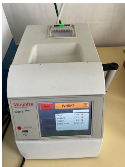
13. ábra: Búza szemtermés sikér, nedvesség, fehérje, Zeleny-index vizsgálata Mininfra-ScanT NIT Analyser eszközzel (Forrás: saját fotó)
