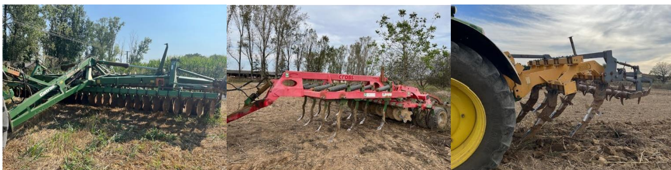
7.ábra: A kísérletben alkalmazott eszközök balról jobbra: Amazone Catros 7500 rövidtárcsa, Unia Cross 3 méteres kultivátor, Dondi 5 késes lazító (Forrás: saját fotók)
