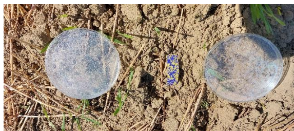
7. Kép: Csepp méret a petri csészén és a vízerzékeny papíron
