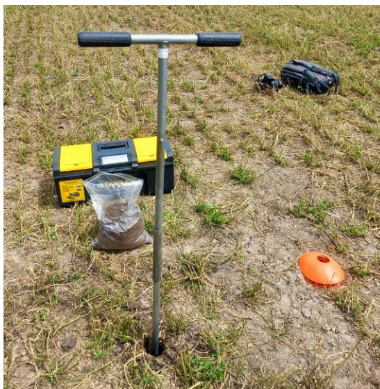
5. ábra: Fúrással elvégzett mintavétel Vátyon középkori település egyik középkori gödörobjektumából (forrás: saját fotó)
