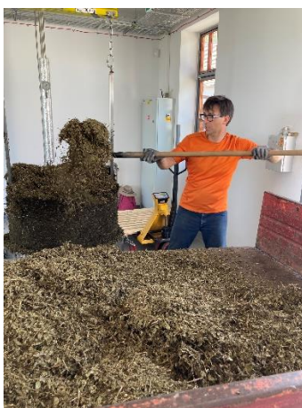
15. ábra: Borsosmenta ( Mentha x piperita L.) lepárolt szárítmány kipakolása pótkocsira a lepárlóüstből
