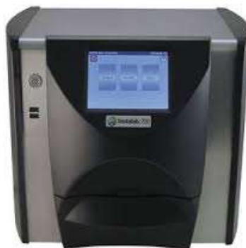
12. ábra: Dickey-John Instalab 700 gabona mérő műszer ( http8 )
