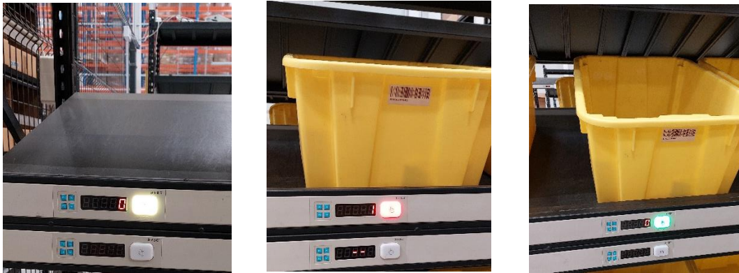
20. ábra Megrendelés állapotát jelző lámpák (Balról jobbra: Sárga: új rendelés, Piros: Adott termék megrendelése, Zöld: Rendelés elkészült) Forrás: Saját felvétel
