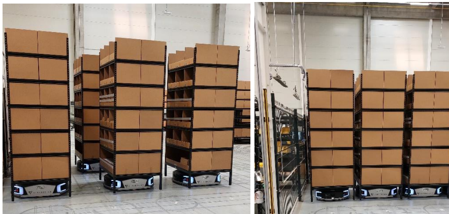
19. ábra Komissiózó robotok érkeznek polccal a munkaállomásokhoz Forrás: Saját felvétel
