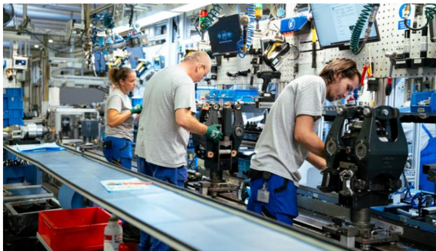
3.kép: Egydarabos áramlás szerint kialakított főszori szerelés (Forrás: saját fotó – 2024.10.10.)
