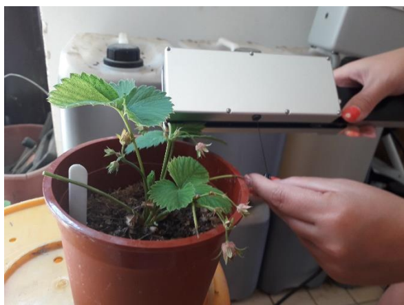
10. ábra Levélfelületmérés Li- 3000 C típusú műszerrel.
