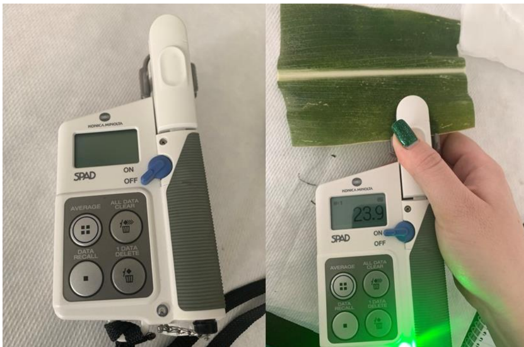
7. kép: SPAD mérőműszer, és annak működése (Püski, 2024).
