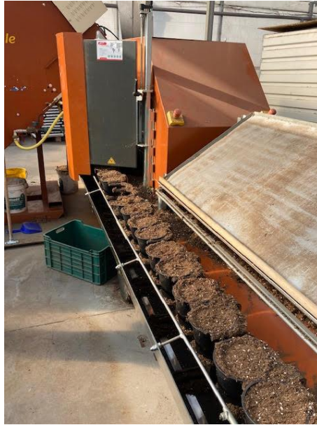
22. ábra: Cseréptöltő gép működés közben Forrás: saját felvétel, 2021. október 16.
