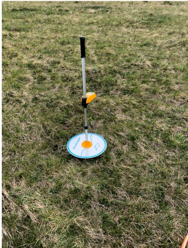
15. ábra: A Grasshopper G2 RPM típusú tárcsás hozam-becslő (Forrás: KOVÁCS, 2022)
