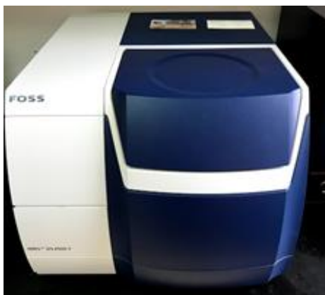
17. ábra: FOSS NIRST™ DS2500F típusú terményanalizáló berendezés (fotó: LEPOSSA, 2021)
