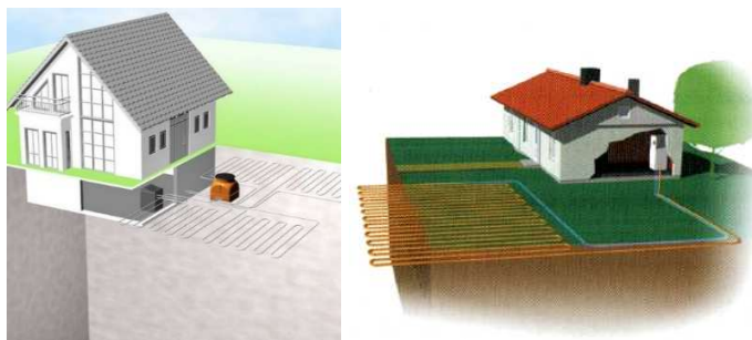
9. ábra: Talajkollektor (Ádám et al. 2013.)
