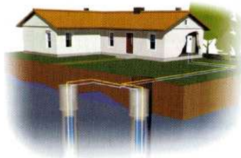
15. ábra: Vízkútpáros hőszivattyús rendszer (Ádám et al. 2013.)
