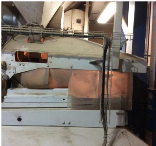
14. ábra: A fajsúly szeparátor. Saját készítés.
