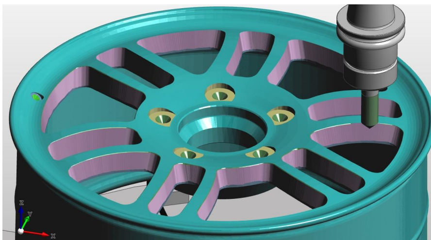
34. ábra: A furatközpontok és a felső élek sorjázása 90°-os központozóval (Saját ábra)
