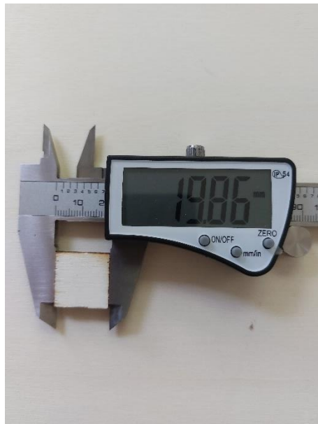
13.3-2. ábra Próbadarab mérése tolómérővel
