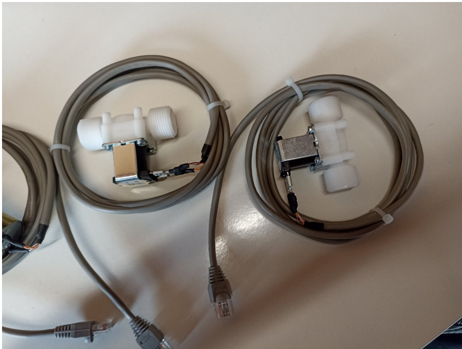
23. ábra. A „felvezetékelt” mágnesszelepek
