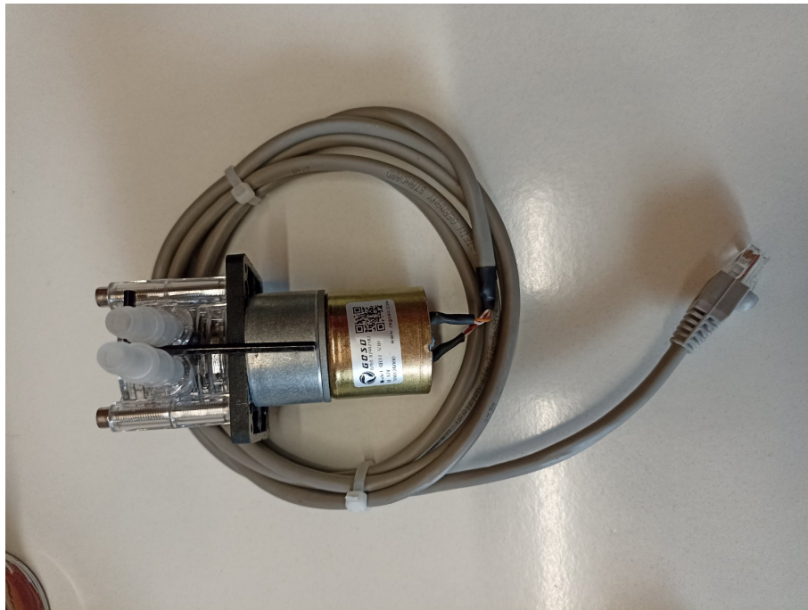
21. ábra. A „felvezetékelt” perisztaltikus (vegyszeradagoló-)szivattyú
