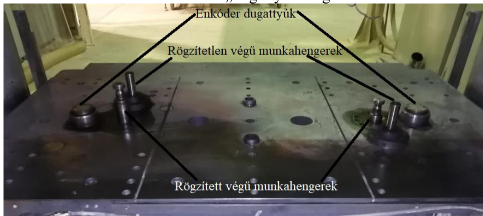
22. kép Az általunk használt sajtógép kiemelő berendezésének munkahengerei és enkóder mozgásalakítói
