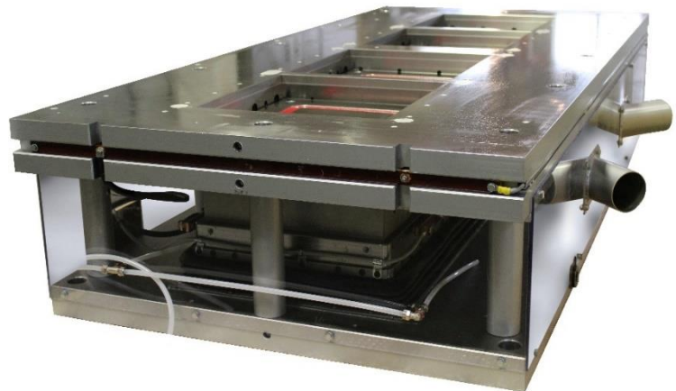
60. kép Zárt porvédelemmel és elszívással ellátott beható szerszám [20]
