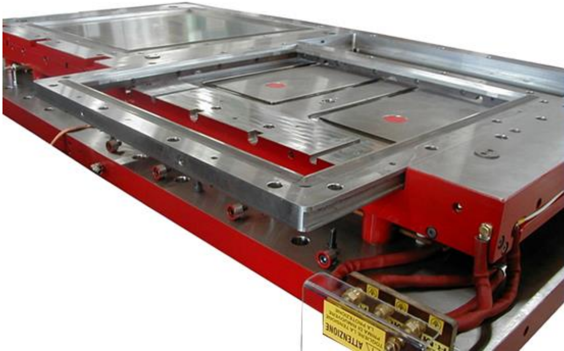
57. kép Oldal irányban eltávolítható szerelt betét [17]
