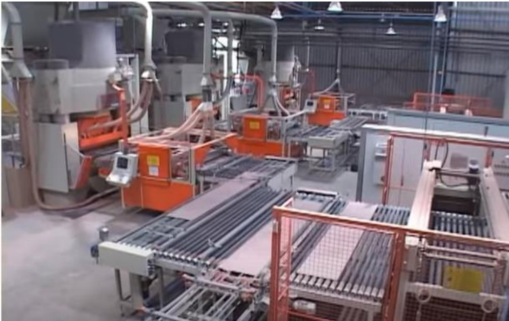
16. kép Burkolólapgyártó sajtógépek és összekötött szállítópályájuk a szárító kemencével
