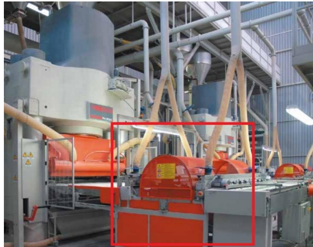
15. kép Sacmi PH 2000-rs sorozatú gép, piros négyzetben kiemelve a lapfordító berendezés [6]
