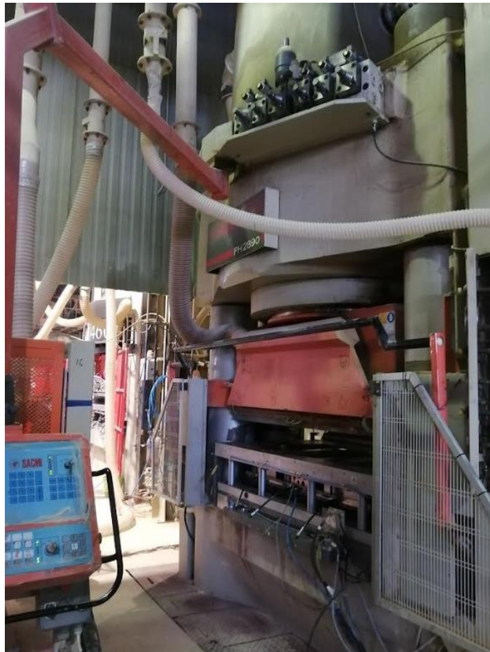
66. kép Az elkészült szerző a sajtógépbe szerelve
