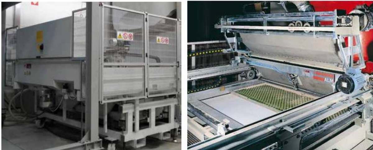
7. kép Sacmi töltőegység (balra) és a benne lévő töltővályú és töltőkocsi (jobbra) [6]
