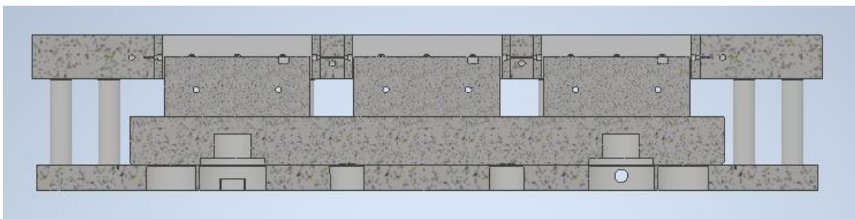
46. kép A végleges szerszámmodell metszeti képe
