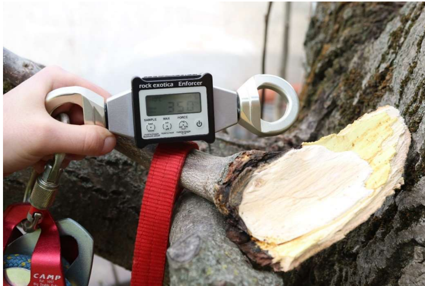
21. ábra: Modern erőmérő cella (Forrás: saját felvétel, 2020.)
