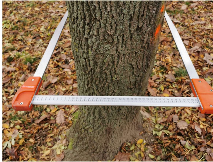
4. ábra: Törzsátmérő mérése átlalóval (Forrás: saját felvétel, 2024.)
