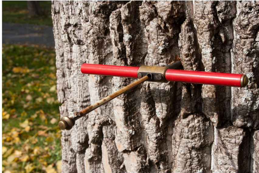
12. ábra: Presler fűrő kihúzott növedécsappal (Forrás: saját felvétel, 2015.)
