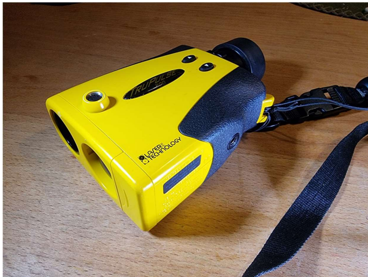
3. ábra: TruPulse lézeres famagasságmérő készülék (Forrás: saját felvétel, 2023.)
