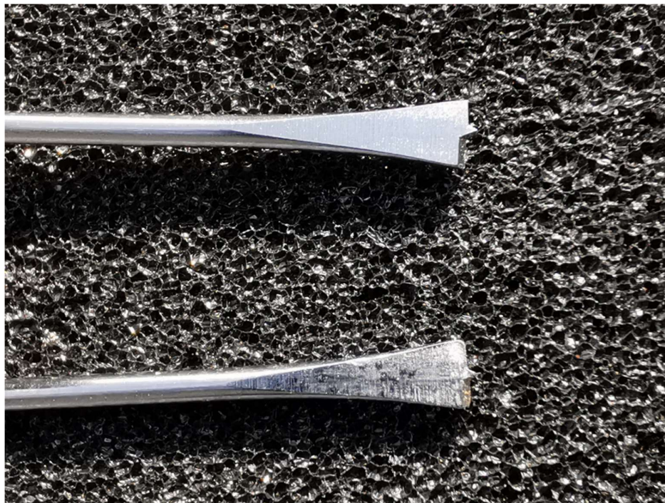
18. ábra: Fűrásellenállás mérő fűrészárak, lent a használt, kopott, fent az új (Forrás: saját felvétel, 2022.)
