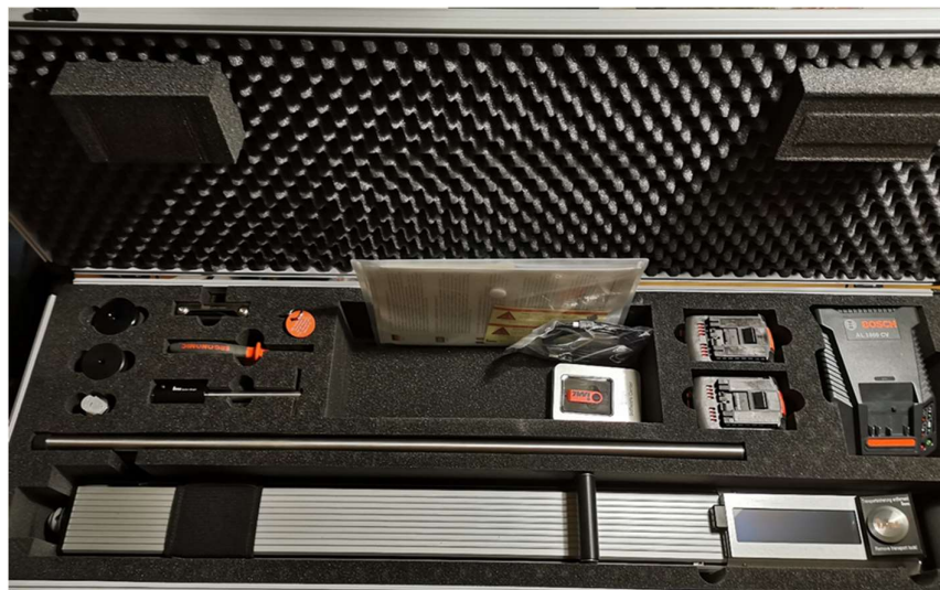
17. ábra: IML Resi fűrésellenállás mérő készülék (Forrás: saját felvétel, 2022.)
