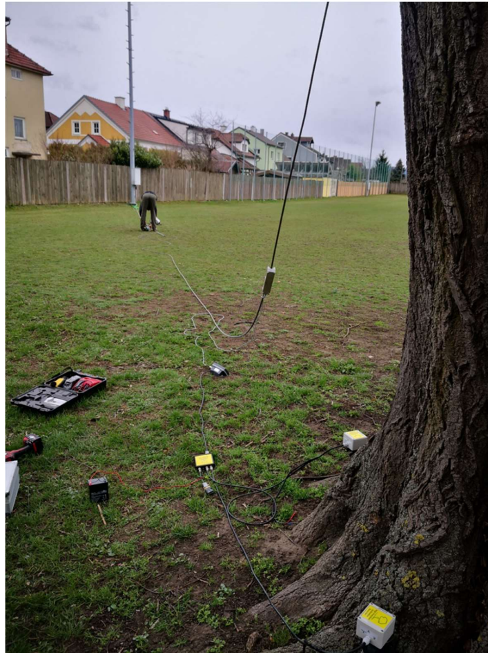
20. ábra: Húzásos gyökérvizsgálat (Forrás: saját felvétel, 2019.)
