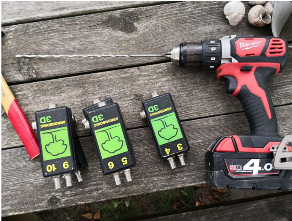
10. ábra: Fakopp erősítődobozok és favizsgáló fűrészar (Forrás: saját felvétel, 2022.)
