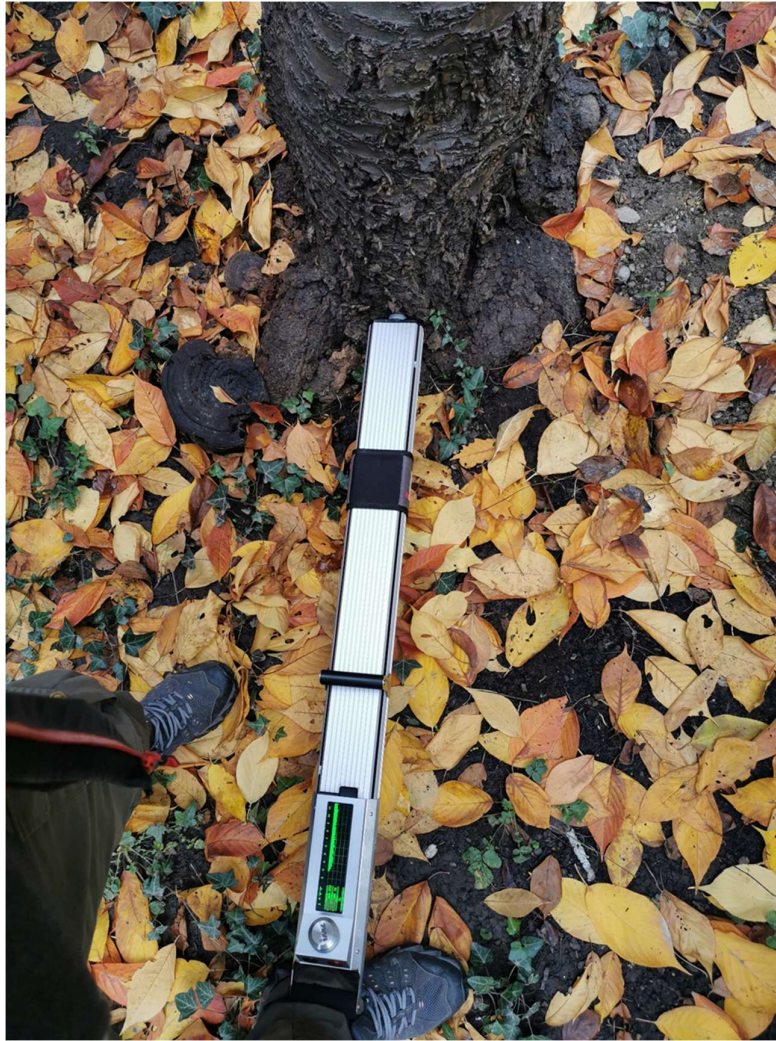
17. ábra: IML Resi fűrésellenállás mérő készülék (Forrás: saját felvétel, 2022.)
