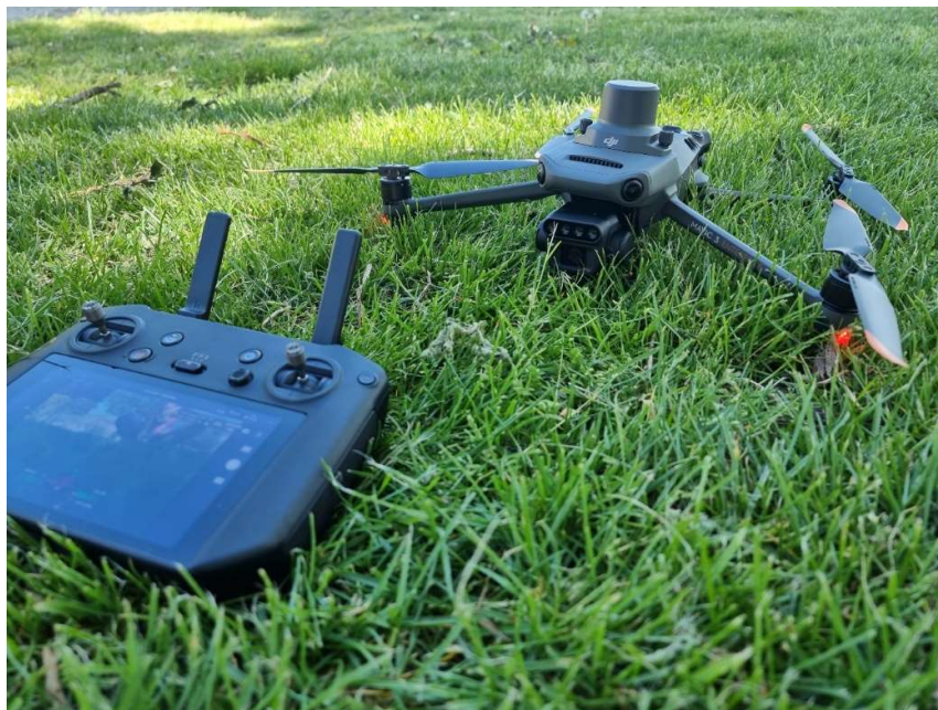
32. ábra: A kamera egy hagyományos RGB és négy speciális hullámhosszú szenzort tartalmaz (Forrás: saját felvétel, 2024.)
