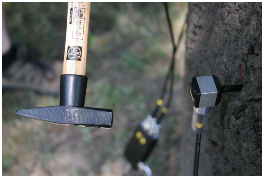
9. ábra: Fakopp érzékelő és jeladás (Forrás: saját felvétel, 2014.)
