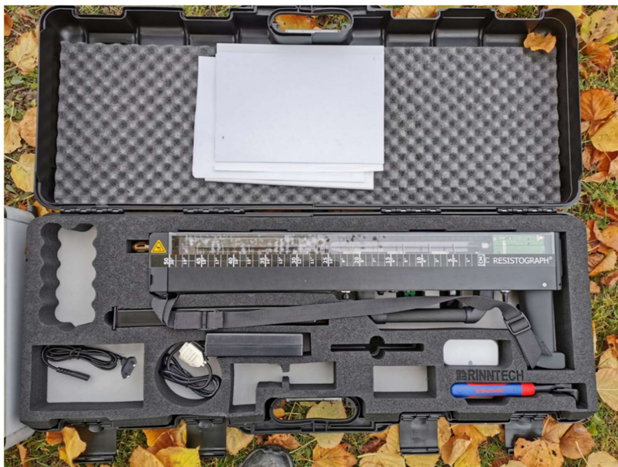
15. ábra: Rinntech Resistograph fűrészellenállás mérő készülék (Forrás: saját felvétel, 2023.)
