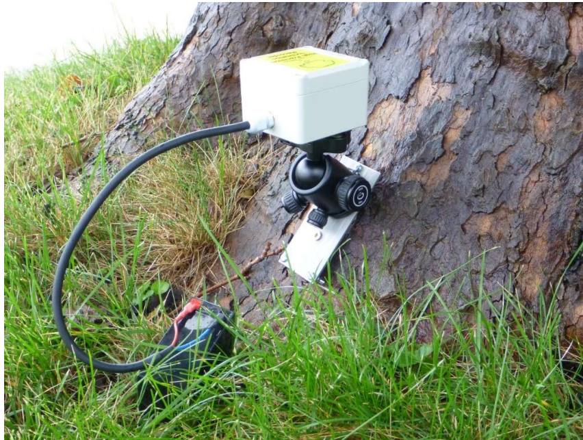
27. ábra: Dinamikus szélteher vizsgálat a fa gyökérzetének állapotát mutatja meg (Forrás: saját felvétel, 2020.)
