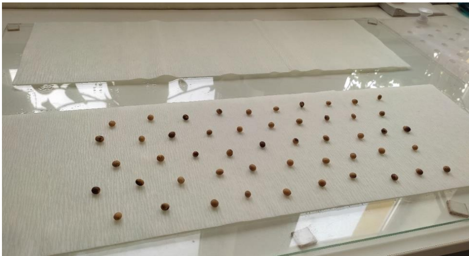
14. ábra: Magok lerakása sablon segítségével (Forrás: saját fotó, Lajtamag Kft. 2024.)
