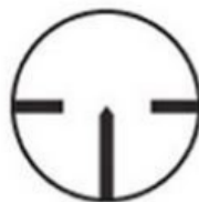
12. Ábra: Ezen a szálkeresztben az oldaltüskék közötti rész szolgál egy viszonyítási méretként. (Forrás: www.ctp65.fr )
