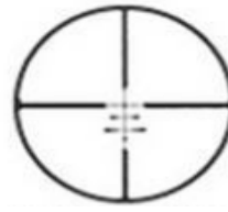
16. Ábra: Távolságbecslésre használatos szálkereszt, MOA vagy MRAD rendszer szerint beosztva. (Forrás: www.ctp65.fr )
