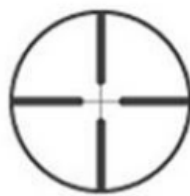
10. Ábra: A „négy-oszlopos” irányzójel jól látható gyenge fénynél és középső rész nem takarja ki a célt. (Forrás: www.ctp65.fr )
