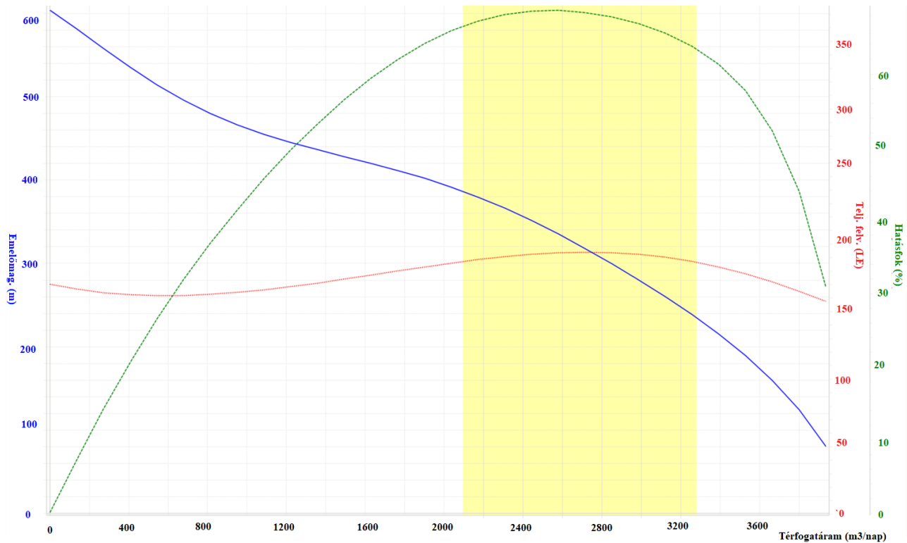
17. ábra: 30 fokozatú REDA JN21000 szivattyú jelleggörbéje (slb ESP szimulátorral, Saját szerkesztés)
