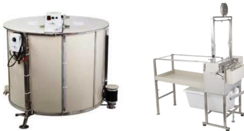
15. ábra: 48 db ½ NB félkerethez gyártott Pergető, Rezgőkéses fedelezőgép (Forrás: Saját ábra, saját eszközről)
