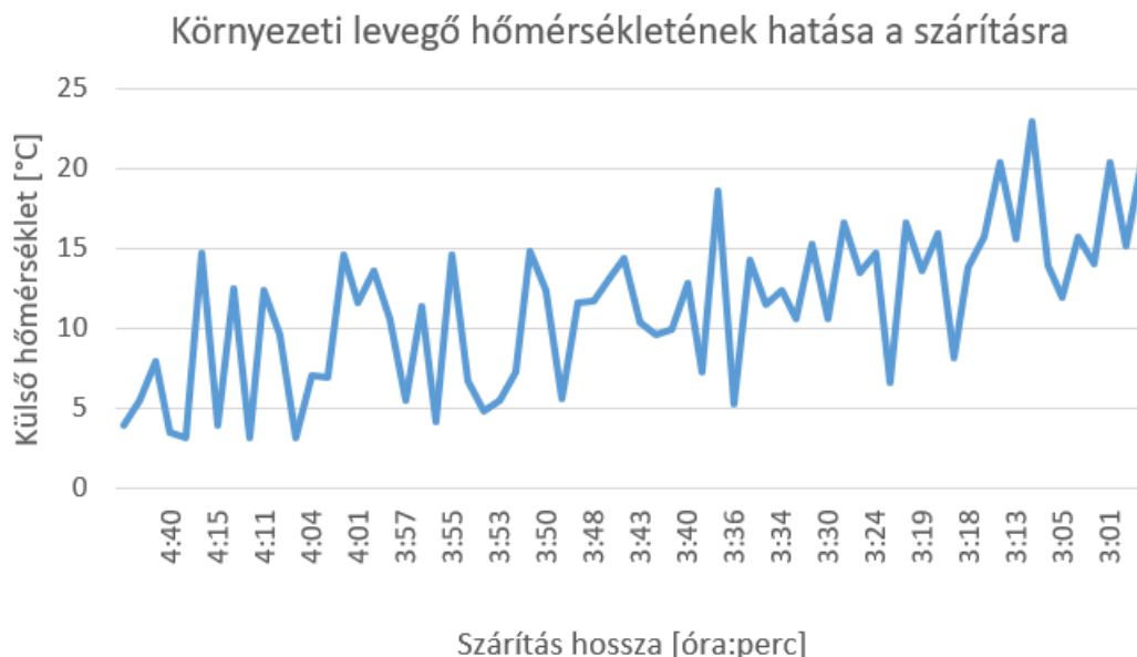
18. ábra Környezeti hőmérséklet hatása a szárítási időre [saját készítés]
