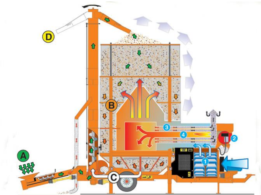
124. ábra Agrex PRT 200 ME szárító működési vázlat [http://agrex.it]
