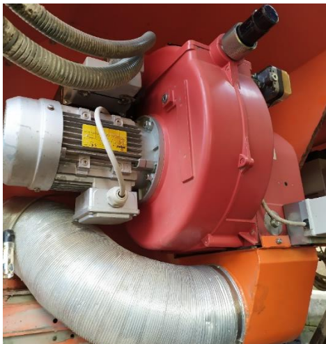
15. ábra PT 71 típusú gázégő (bal oldal) Fő hajtó motor (jobb oldal) [saját készítés]
