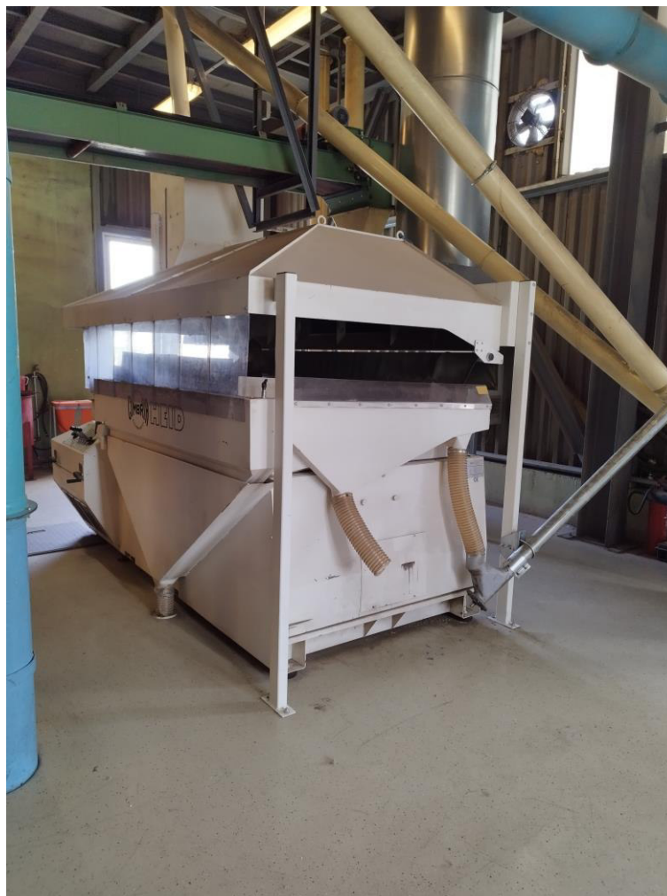
26. ábra: Fajsúlyszeparátor, Tök 2023 ősz (saját felvétel)
