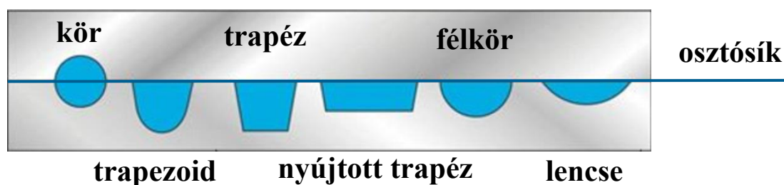
16. ábra Beömlő csatorna típusok (forrás: Dr. Pataki Tamás István – CAE III előadás)
