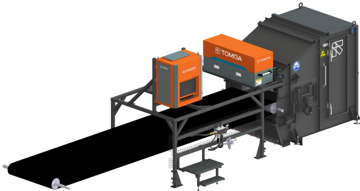
11. ábra: Tomra Autosort gyártmányú optikai szeparátor [8]
