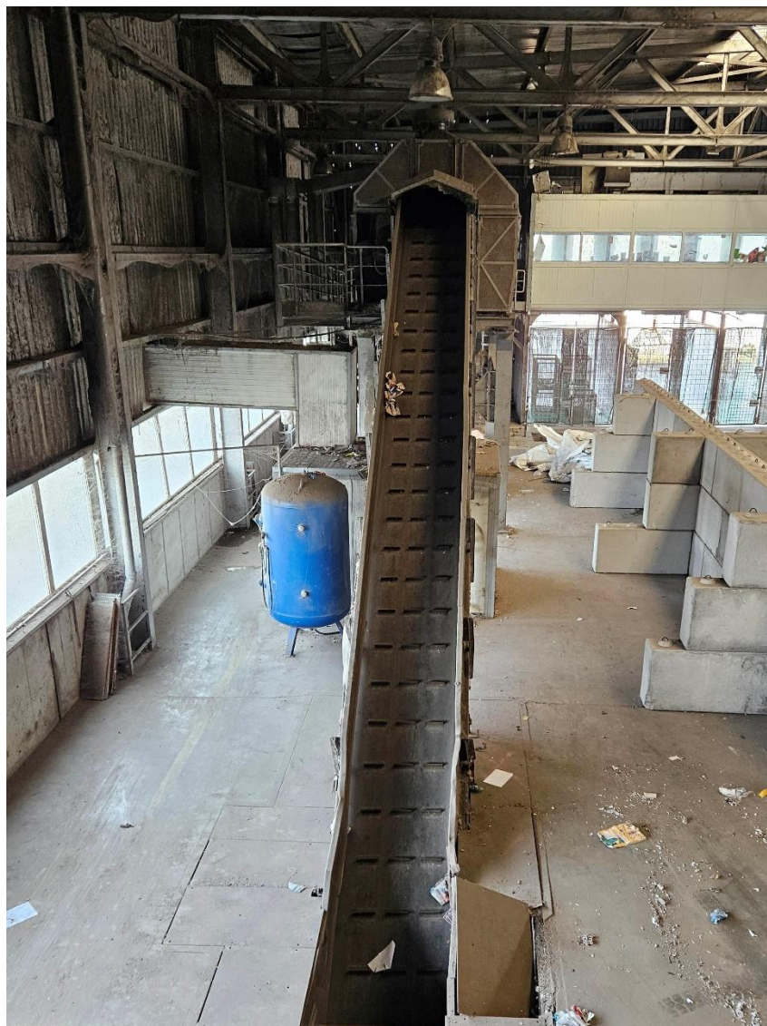
6. ábra: Dörzshajtásos bordázott szállítószalag dobrosta feladáshoz - Miskolci válogatómű - Szerző képe – 2024.
