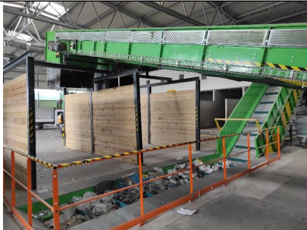
Optikai szeparátoron leválogatott hulladékok átmeneti kitároló boxai és kézi válogató lánchevederes felhordó szalag
