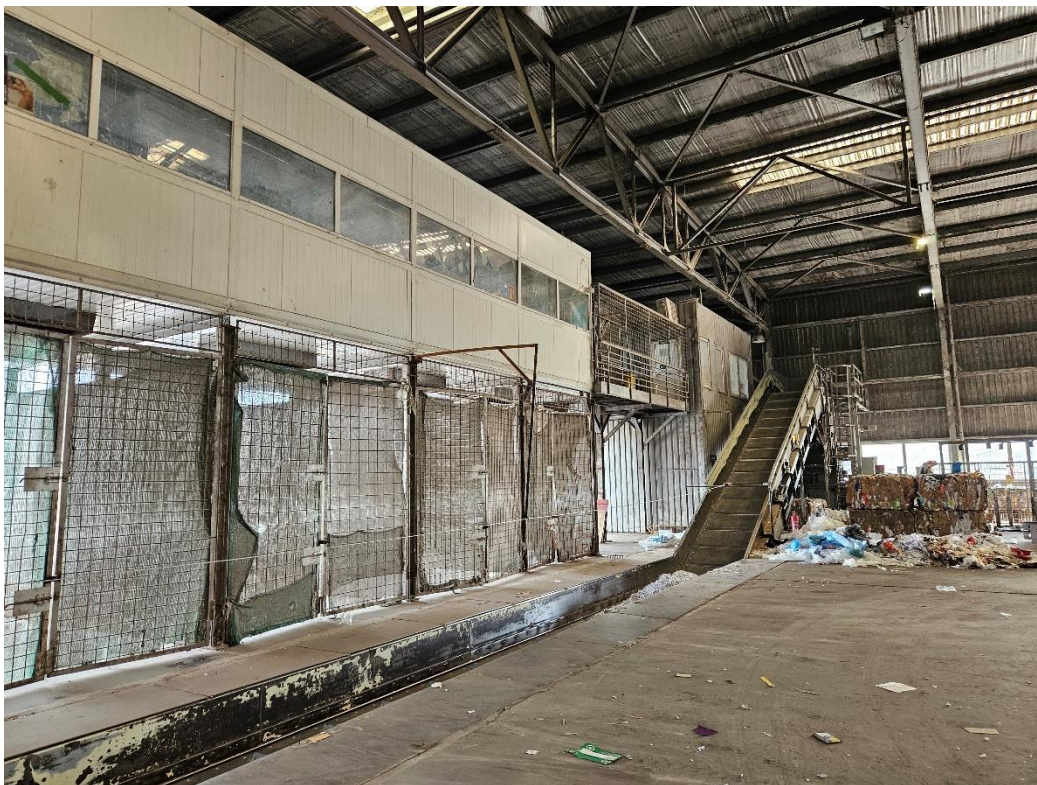
4. ábra: Lánchevederes felhordószalag bálázóra - Miskolci válogatómű - Szerző képe 2024.
