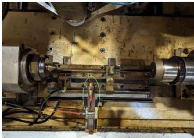
5.29. Fogközé álló mérő szenzor
